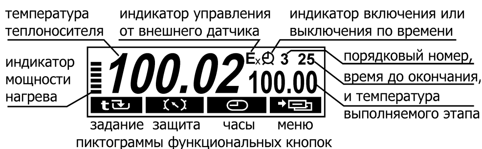
Рисунок 4 — Дисплей в режиме регулирования по программе
